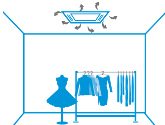
Distribution de l'air avec un filtre poussiéreux
